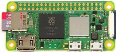
Fig. 1. Raspberry pi 02w
