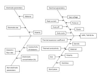
Fig. 2.1: Process parameters of EDM
