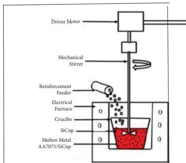
FIG 3.1.1 STIR CASTING
