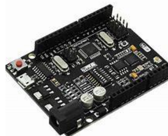
Fig 4.2 ARDUINO UNO WIFI ATMEGA328 + ESP8266
