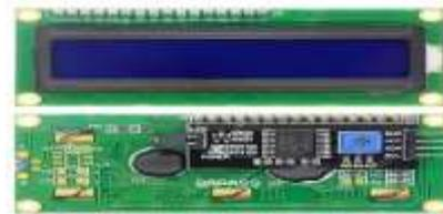
Fig 7. LCD display 16\*2
