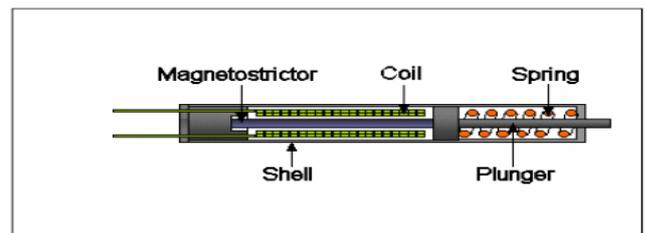
Fig. 6:- MSM's actuator
