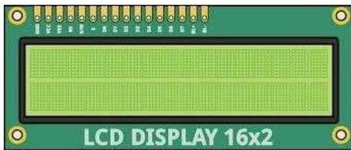
**Fig 4:** 16\*2 LCD display
