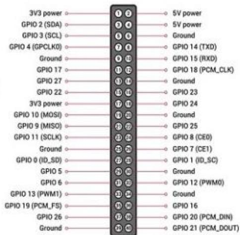
Fig: Pin Diagram
