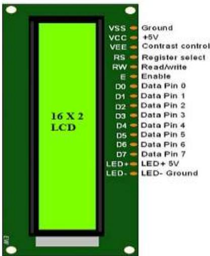
Fig.4. LCD 16x2
