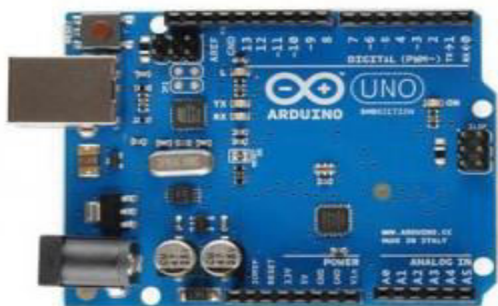
Fig -3: Arduino Uno
